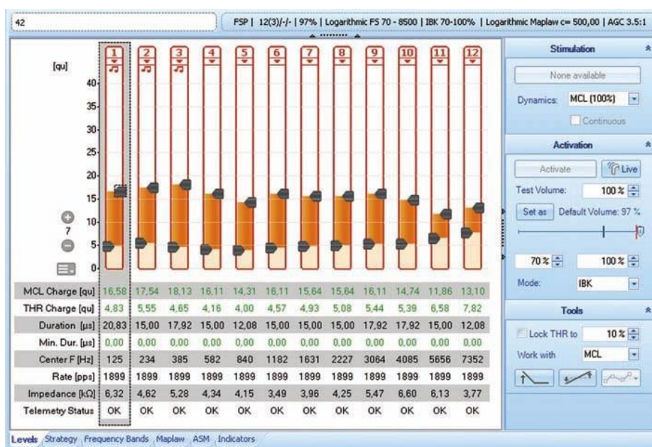
Figura 10. Apariencia de la pantalla de ajuste de MCL, THR e impedancia, entre otros factores. Software MAESTRO de MED-EL versión 7.0
