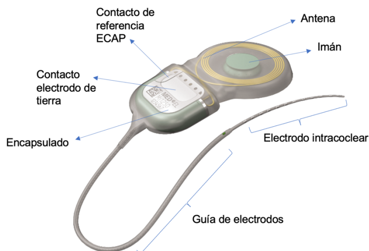
Figura 5. Partes que componen un implante coclear. Implante coclear Synchrony 2.
