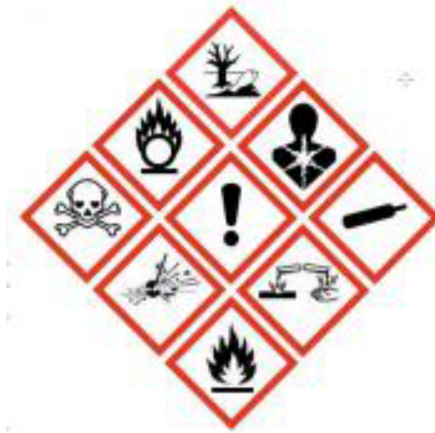
Figura 6: Nuevo formato de los pictogramas de peligro para las sustancias químicas para etiquetas y fichas de seguridad
