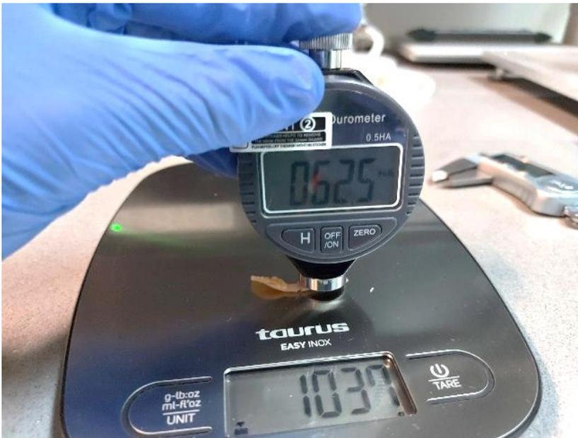
*Ilustración 35 Medición con durómetro digital sobre báscula a 1 kg de presión.*
