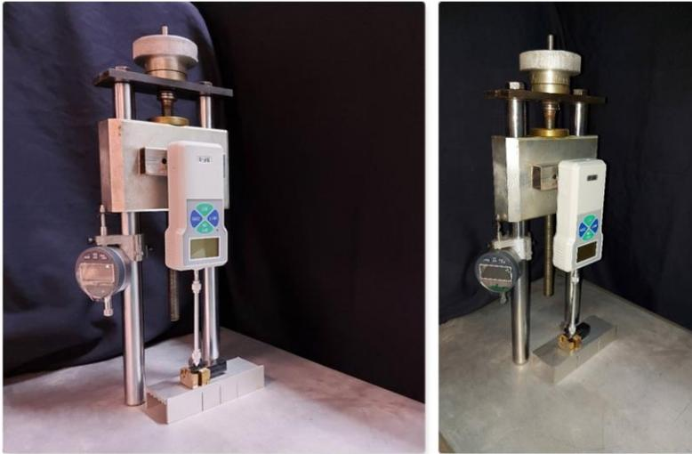
*Ilustración 40 Soporte diseñado para el estudio con control de desplazamiento milimétrico mediante rueda en la parte superior, dinamómetro digital en el centro de la imagen y medidor de desplazamiento vertical a la izquierda del soporte*
