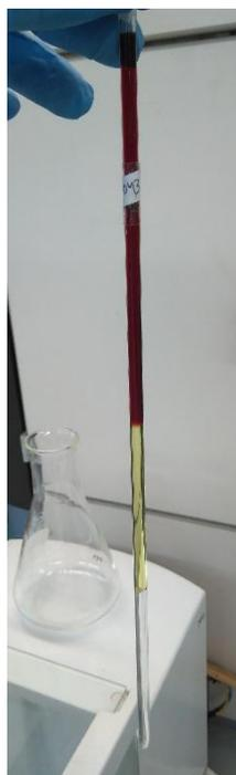
**Figura 5.44.** Tubo de difusión lenta en el que se observa la disolución con el precursor en la parte superior (rojo), con la fenacina en la zona intermedia (amarillo) y con el metal en el tercio inferior (incolore).
