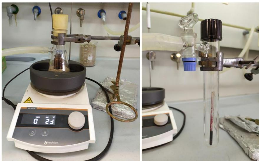
**Figura 5.42.** Montajes empleados para la preparación de la disolución reductora de naftalenuro de litio (*izquierda*) y para la reducción de las redes metal-orgánicas (*derecha*).
