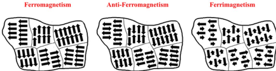
**Figura I.32.** Visión esquemática del comportamiento ferro-, antiferro- y ferrimagnético.
