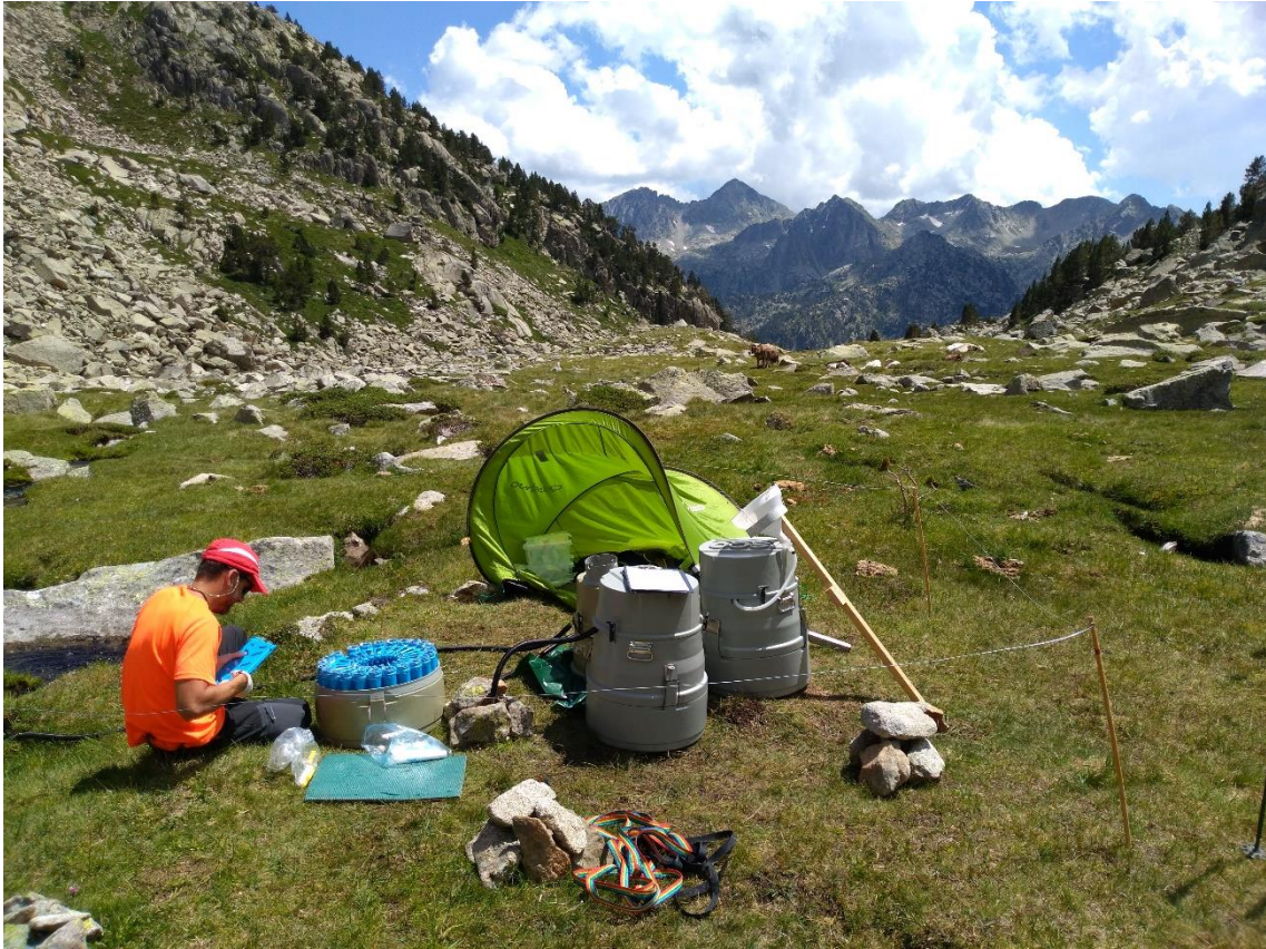
Figura 12. Mostatge del sistema auto-mostrejador a la zona A2, al Cap de la Ribereta (Contraix).
