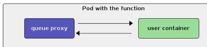
Figura 5.2: El patrón sidecar: el pod con la función contiene un contenedor adicional. Este contenedor envía las solicitudes, obtiene la respuesta, realiza comprobaciones de estado y reintentos, expone métricas, etc.
