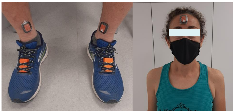
Figura 18. Instrumentación de los acelerómetros triaxiales.
